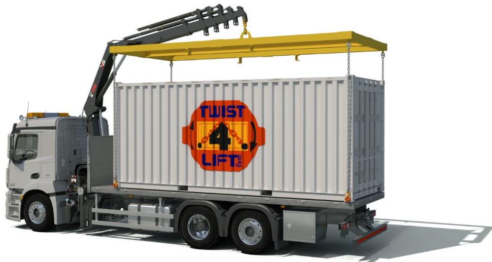
Figur 2. Heben eines Containers mit einem Einzel-Lasttraversen (oben) oder Quer-Lasttraversen (unten) und Twist4lift Containerhaken in den Eckbeschlägen.
